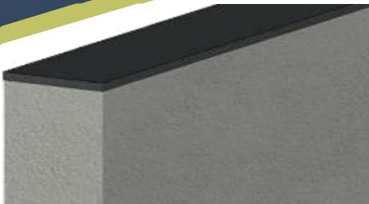
► 1 - Contrôler en premier lieu le support bétonné. Les défauts de planéité doivent être ragrésés.
