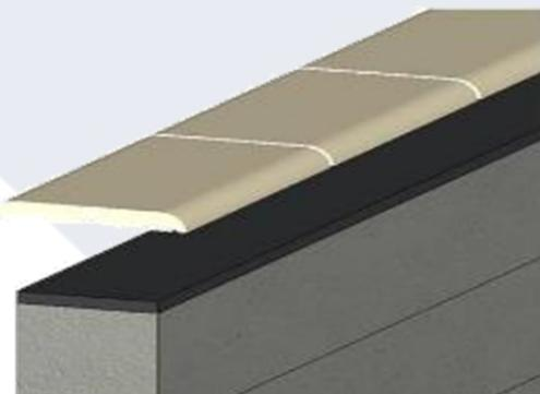
► 5 - Réaliser les joints à la pompe (élastomère) ou à la poche à joint (mortier de jointement) et enlever l'excédent à l'éponge.
