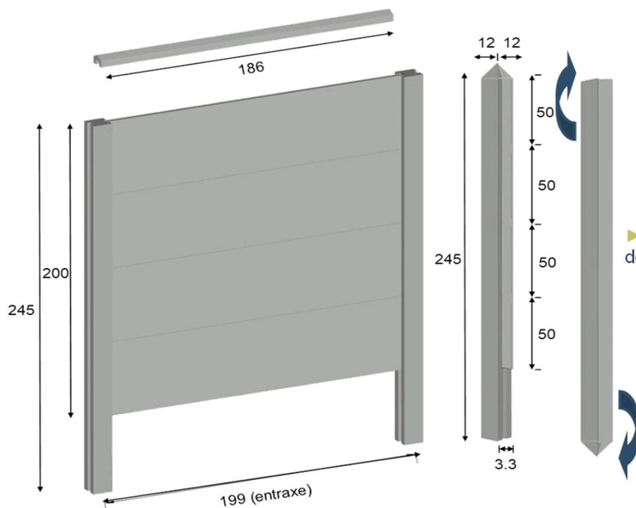
► Poteau en démoulage immédiat réversible avec au choix une finition pointe de diamant ou une finition plate
