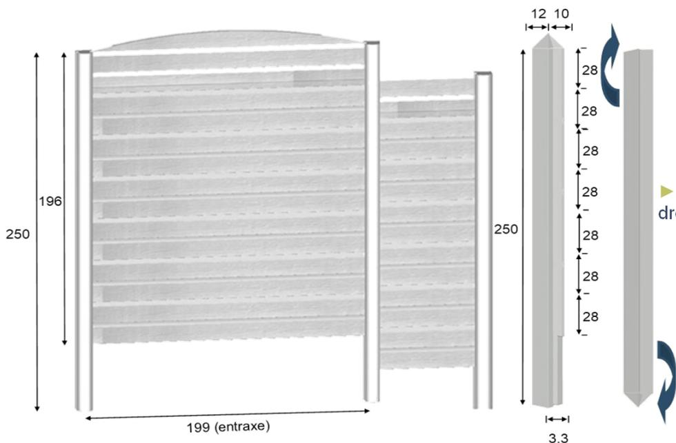
► Poteau réversible avec au choix une finition pointe de diamant ou une finition plate
